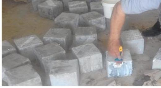
الشكل رقم 7 كيفية تغليف الخرسانة
