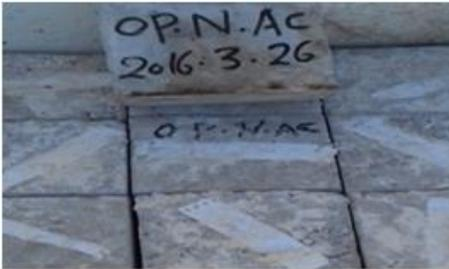
الشكل رقم 6 المكعبات الخرسانية في الهواء الجوي
