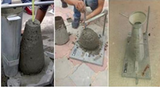
شكل رقم (7): يوضح الادوات المستخدمة وطريقة إجراء الاختبار
