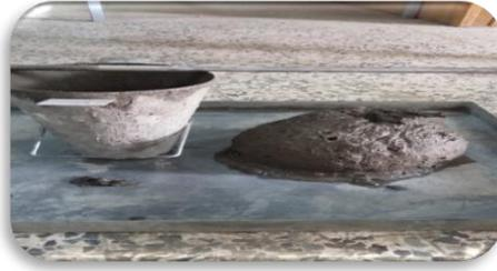
شكل 4 : إختبار الهبوط
