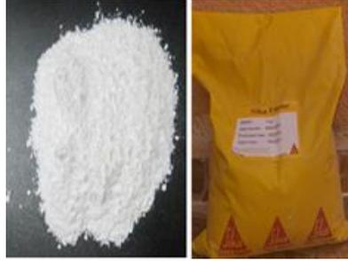
شكل رقم (5): شكل غبار السيلكا
