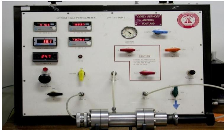
شكل 3: جهاز إختبار النفاذية
