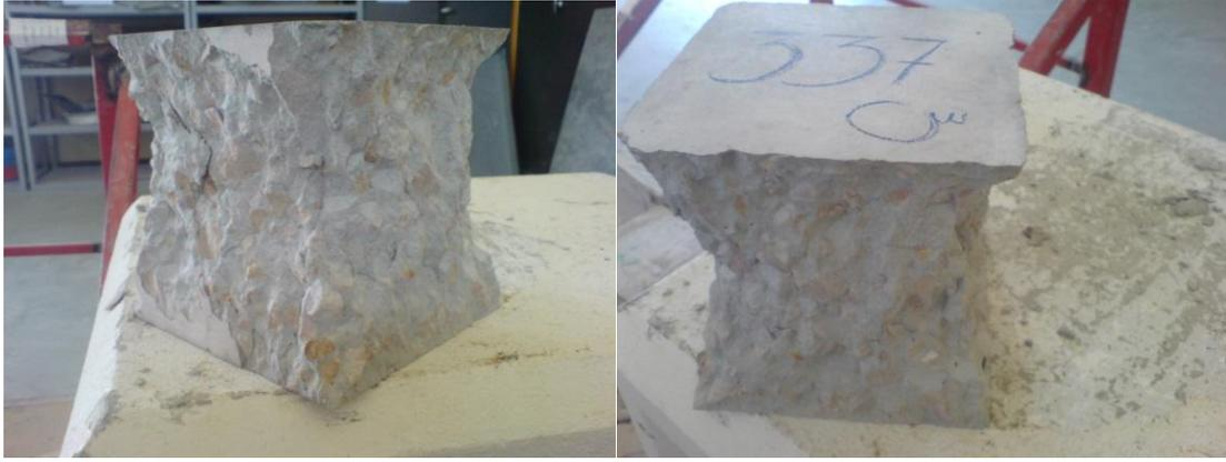
شكل 1: شكل الإنهيار تحت اختبار الضغط لعينات معرضة لدرجات حرارة 250 م° و 500 م°
