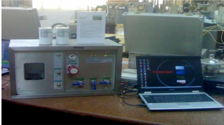
شكل 1: جهاز قياس المسامية
