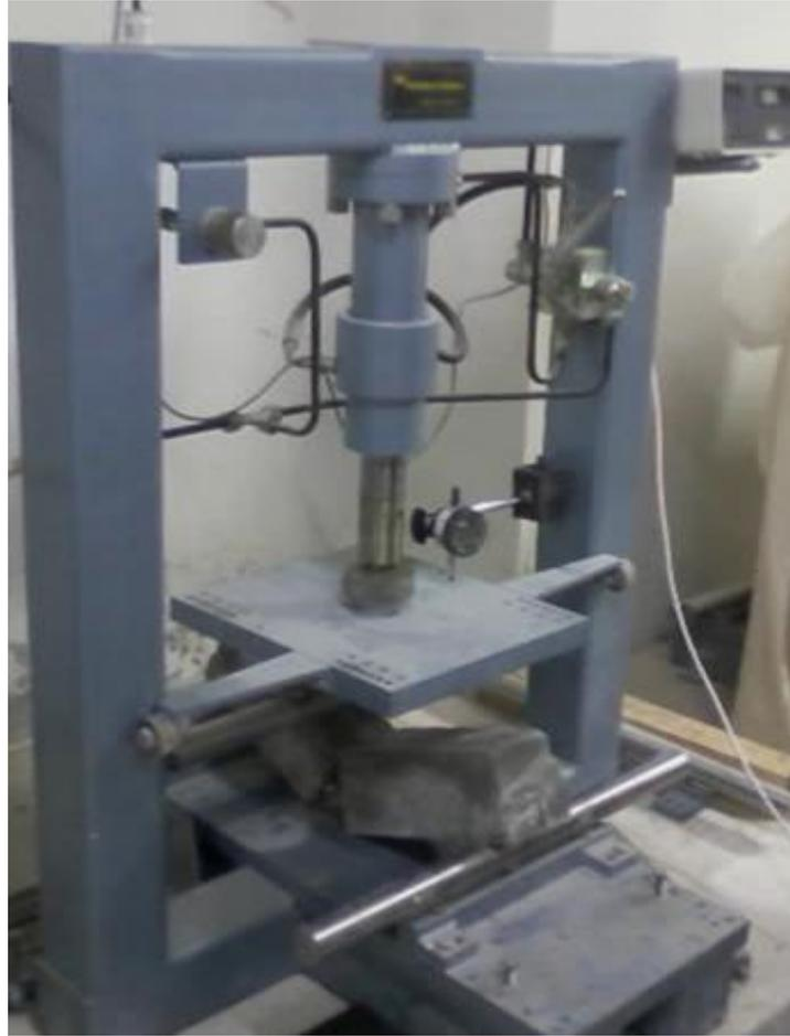
شكل (3) جهاز اختبار مقاومة الإنشاء والهبوط للعتبات الخرسانية
