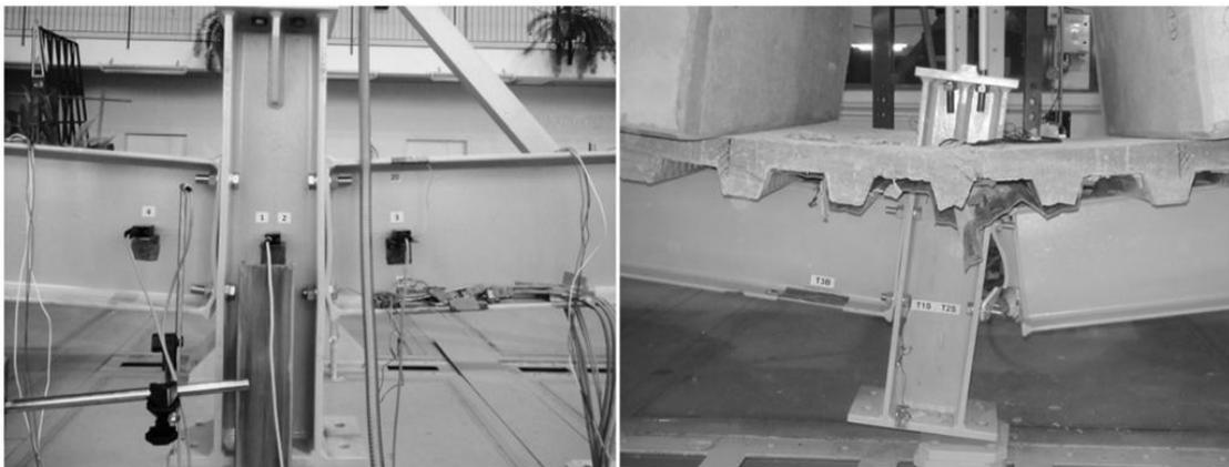
شكل 7 التشوه في المفاصل الداخلية بالنسبة للهيكل الحديدي والخرساني الحديدي
