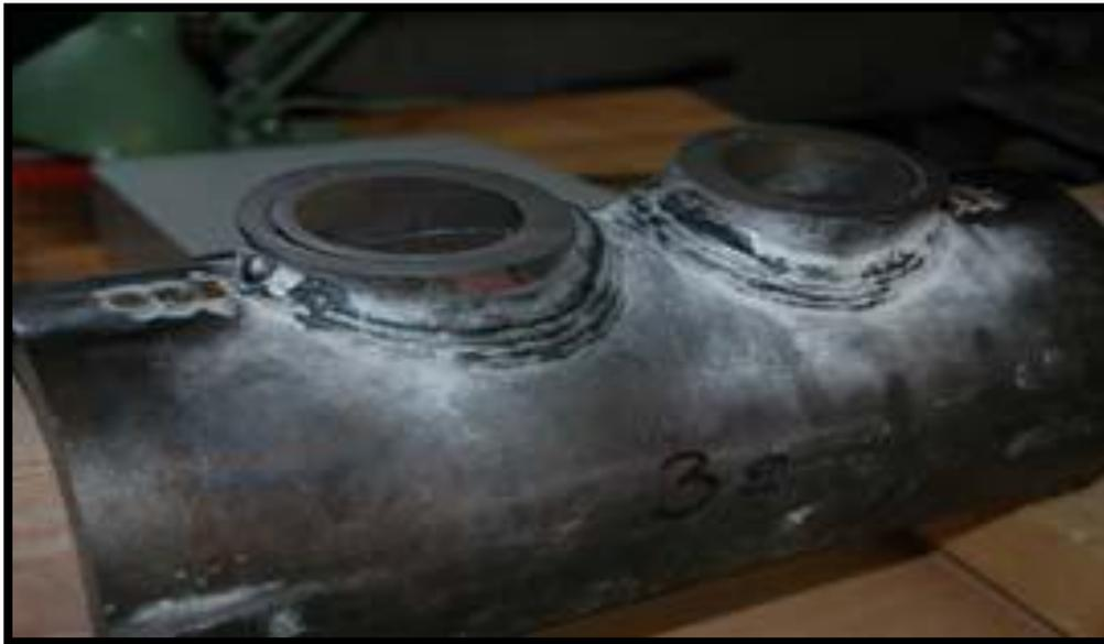
الشكل ( 3.3 ) الوصلة التي أجري عليها الإختبار وأماكن فتحات القياس [6]
