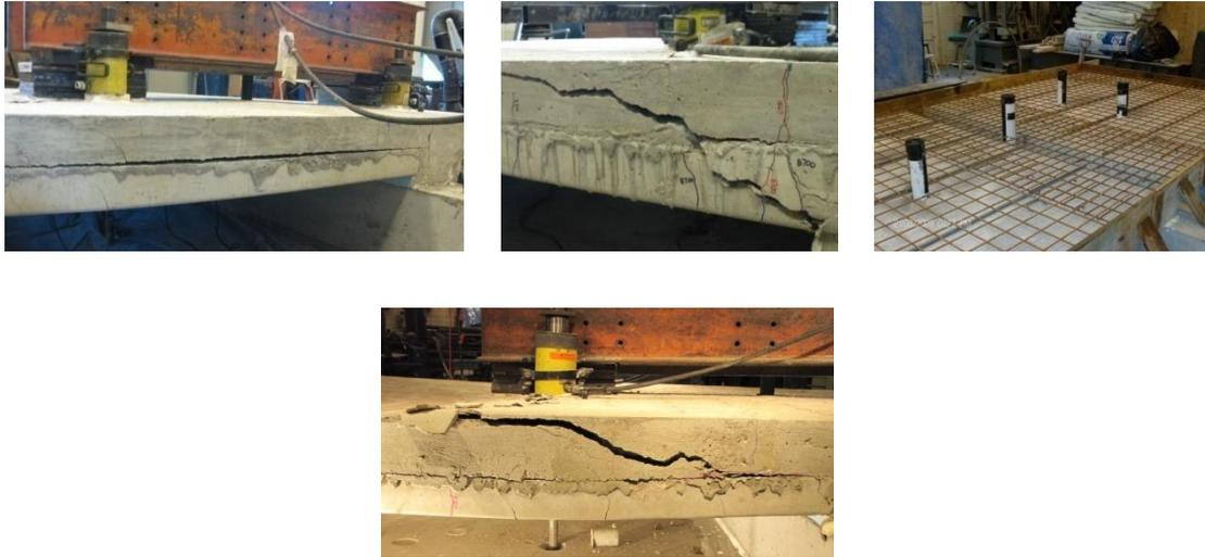
الشكل 13. عينة صور للتجهيز للإختبار وبعض نماذج الإنهيارات للتحميل الداخلي
