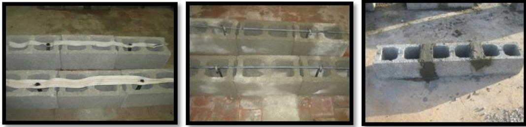
شكل (1-2) كمرة من الطوب فقط، شكل (2-2) كمرة من الطوب المسلحة بالفولاذ، شكل (3-2) كمرة مسلحة بشريط بلاستيكي
