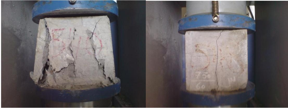
شكل 2: شكل الإنهيار تحت اختبار الضغط لبعض العينات المعرضة لدرجات حرارة 750 م°
