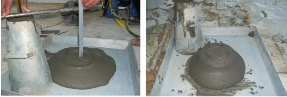
الشكل 1: إختبار الهبوط للخلطات
