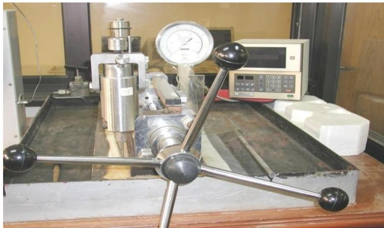
شكل 2: جهاز قياس الحجم الكلي للعينات
