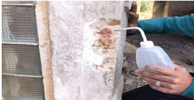
الشكل (4): اختبار الكرينة على سطح خرساني مكشوف حديثاً
