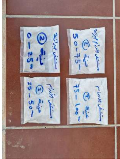
شكل (4-6): جمع المسحوق الخرساني ووضعه في أكياس خاصة
