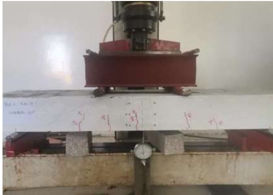
شكل 13: الانهيار للبلاطة (B4)
