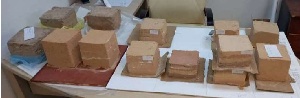
الشكل (8): تجميع العينات بعد فترة جفاف لإجراء اختبارات الضغط عليها
