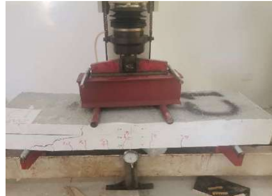
شكل 5: الانهيار للبلاطة المرجعية (A)
