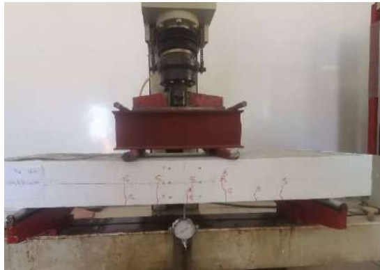
شكل 9: الانهيار للبلاطة (B2)
