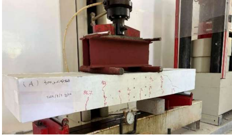
شكل 5: الانهيار للبلاطة المرجعية (A)
