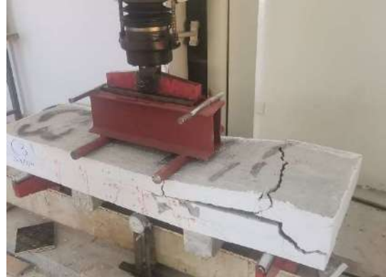
شكل 10: الانهيار للبلاطة (C3)
