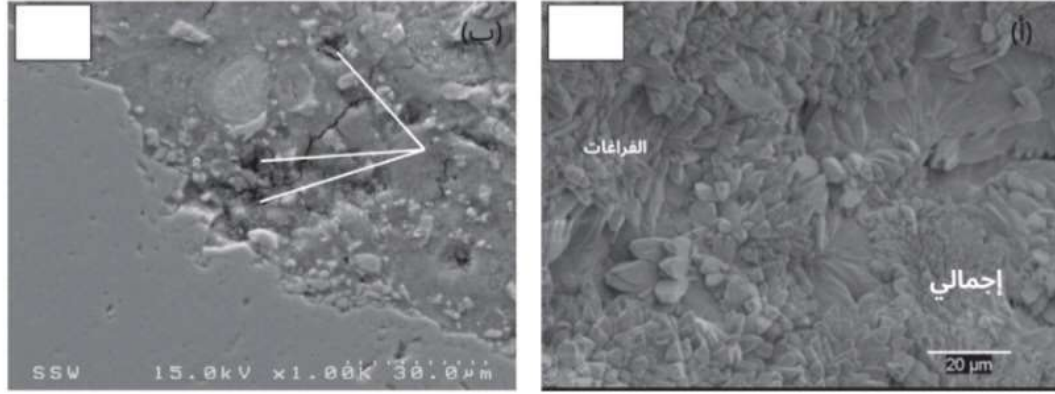
الشكل (5) : حجم الفراغات الناتجة عن تكون الجبس في التفاعل الكيميائي [26]
