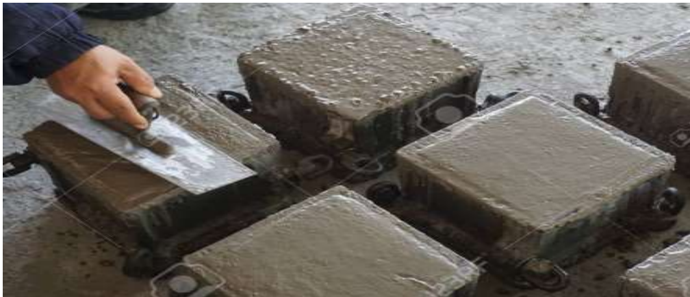
شكل (2) تسوية سطح العينات بعد عملية الصب
