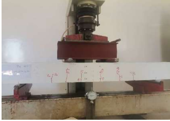
شكل 11: الانهيار للبلاطة (B3)
