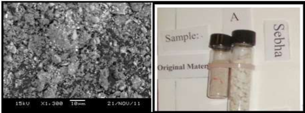
الشكل 4: صورة SEM ولون طين سبها قبل المعالجة الصوتية بطريقة القرن
