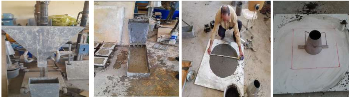
الشكل (5) اختبارات الخواص الطرية للخرسانة ذاتية الدمك بمعمل قسم الهندسة المدنية جامعة وادي الشاطئ
