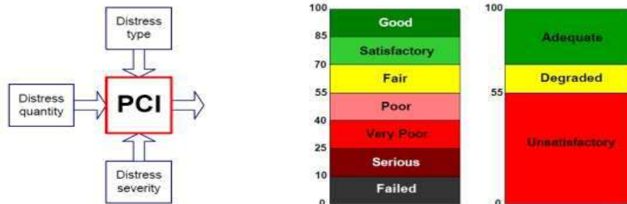
شكل 15: تقييم الطريق حسب قيم معامل الرصف
