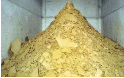
الشكل (2) الطين الناتج عن عمليات النشر والتلميع على الألواح (الطين المجفف بالترشيح بالهواء).
