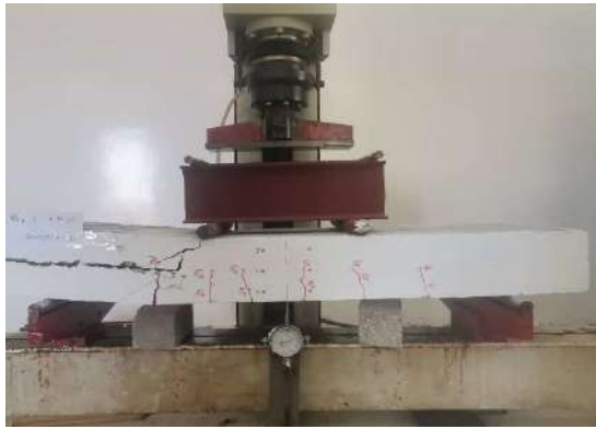
شكل 11: الانهيار للبلاطة (B3)
