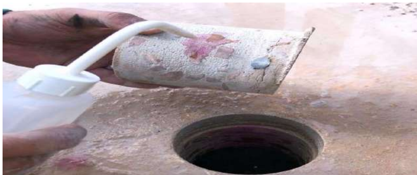
الشكل (5): الاختبار على عينة لب الخرسانة المستخرجة حديثاً
