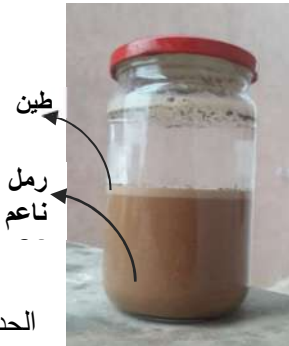
الشكل (6): اختبار الترسيب على التربة
