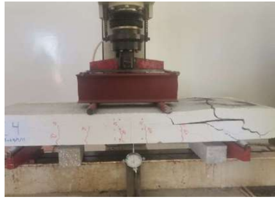
شكل 10: الانهيار للبلاطة (C3)
