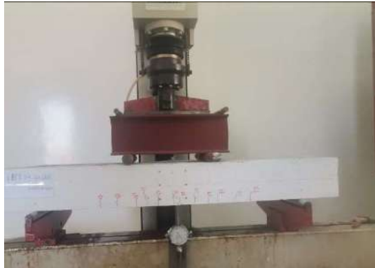
شكل 7: الانهيار للبلاطة (B1)
