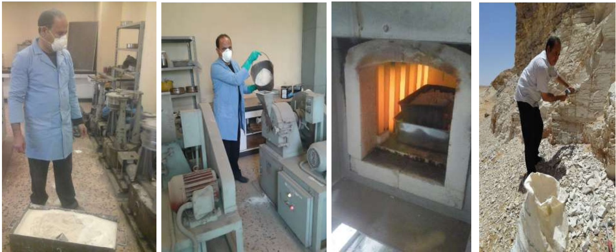
الشكل (3) صورة توضح موقع استجلاب عينة البوزولانا من منطقة تمنهنت تم تكليسها وطحنها ونخلها بمعمل الجودة بمصنع الحديد والصلب مصراتة
