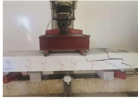
شكل 12: الانهيار للبلاطة (C4)
