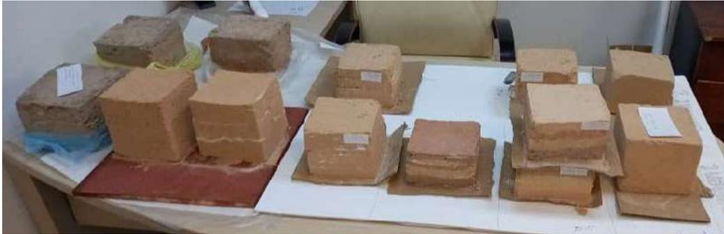
الشكل (8): تجميع العينات بعد فترة جفاف لإجراء اختبارات الضغط عليها
