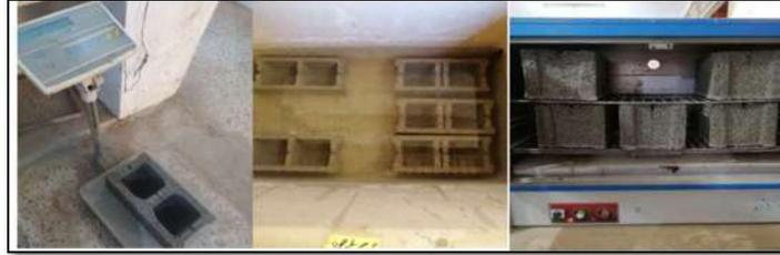
الشكل (3): الأجهزة المستخدمة في اختبار نسبة الامتصاص
