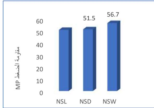
شكل (4) اختبار الضغط للخرسانة
