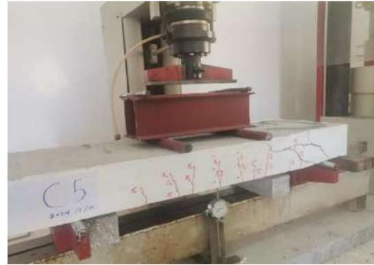
شكل 14: الانهيار للبلاطة (C5)
