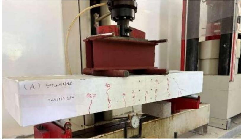
شكل 5: الانهيار للبلاطة المرجعية (A)
