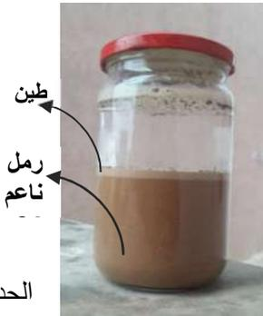
الشكل (6): اختبار الترسيب على التربة
