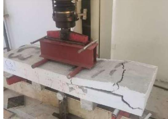
شكل 10: الانهيار للبلاطة (C3)
