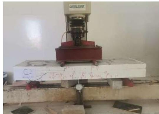
شكل 8: الانهيار للبلاطة (C2)
