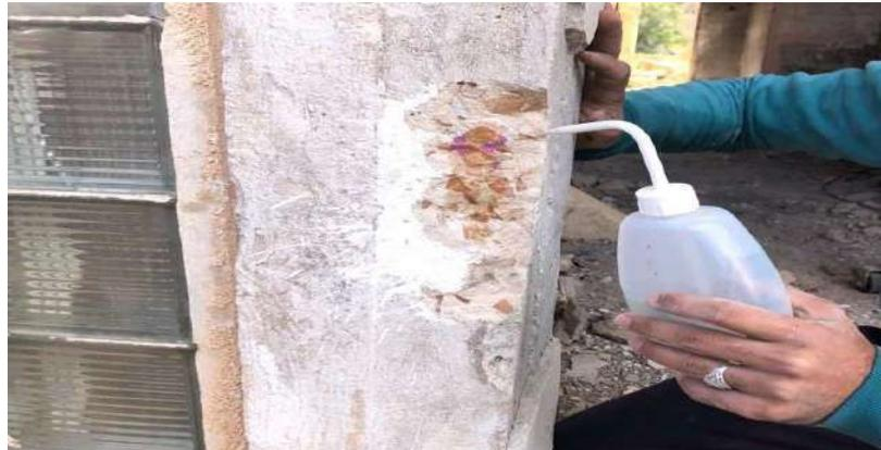
الشكل (4): اختبار الكربنة على سطح خرساني مكشوف حديثاً
