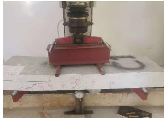
شكل 6: الانهيار للبلاطة (C1)
